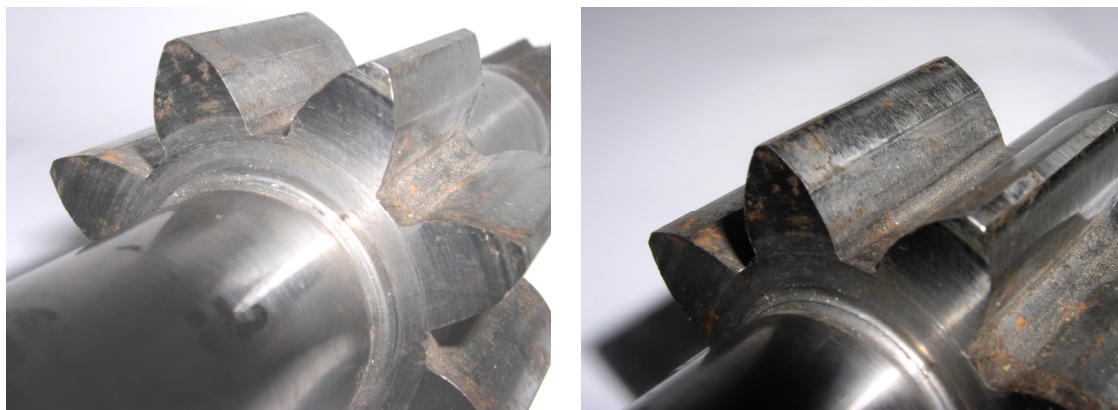
Рис. 16.20. Характер зношення евольвентного профілю ведучої шестерні
