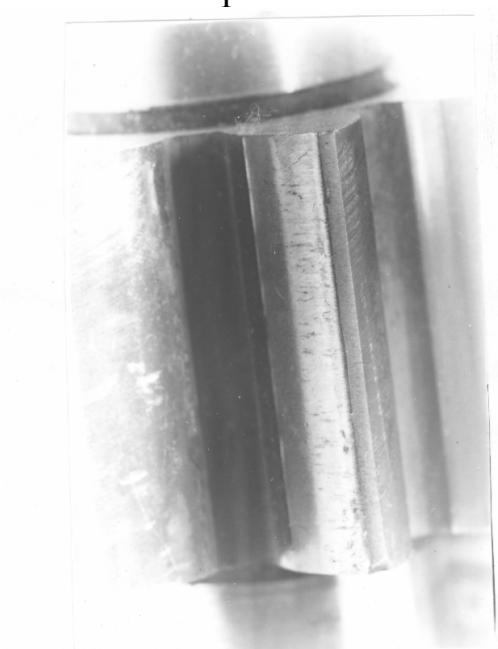
Рис. 16.21. Характер зношення евольвентного профілю веденої шестерні
