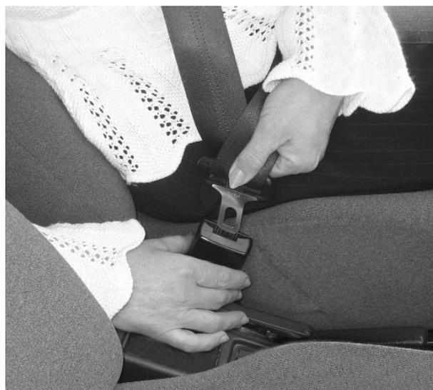
Рисунок 15 - Проверка работы замка ремня безопасности
