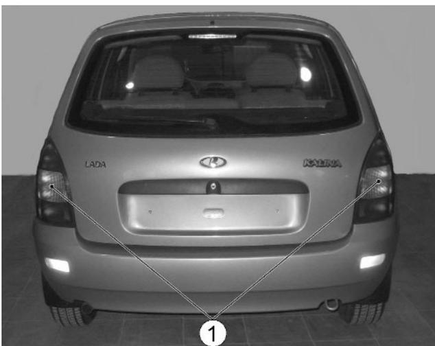
Рисунок 1 - Фонари автомобиля LADA 1117:
