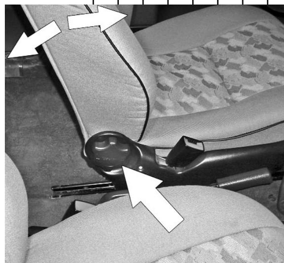
Рисунок 12 - Проверка работы механизма перемещения передних сидений в продольном направлении
