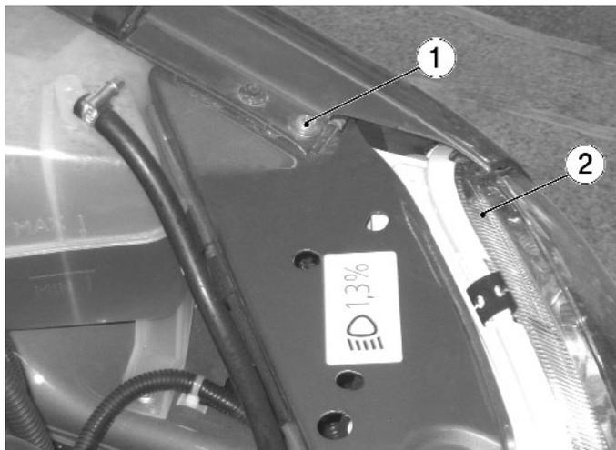
Рисунок 12 - Крепление блок-фары:
