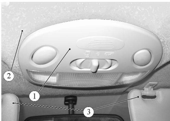
Рисунок 10.1 - Блок освещения салона:
