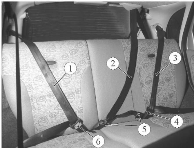
Рисунок 4.1 - Задние ремни безопасности:
