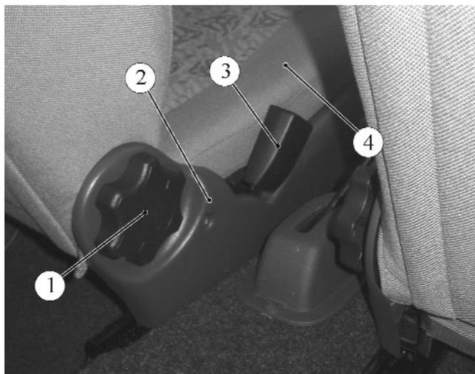
Рисунок 9.4 - Замок переднего ремня безопасности:
