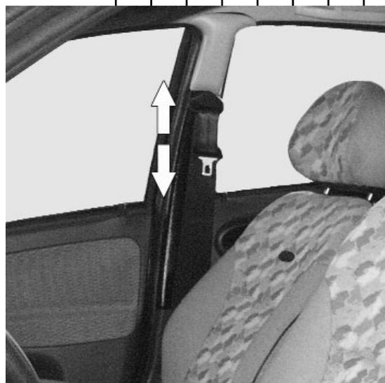
Рисунок 16 - Проверка работы регулятора высоты ремня безопасности
