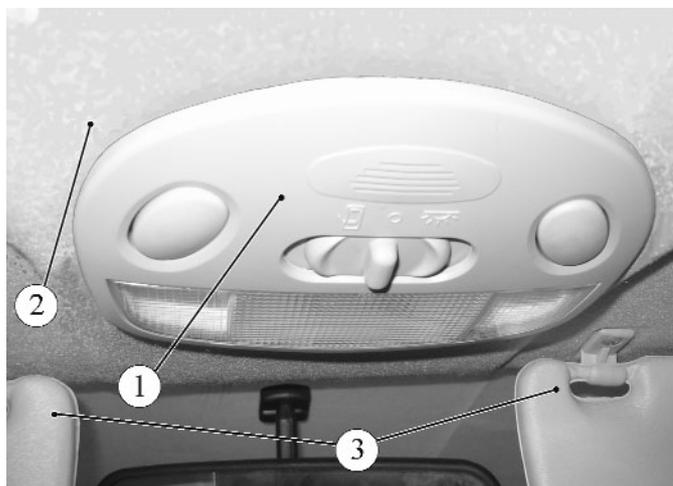
Рисунок 2.1 - Блок освещения салона:
