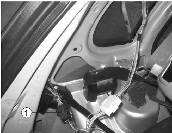
Рисунок 4 - Расположение колодки жгута заднего фонаря:
