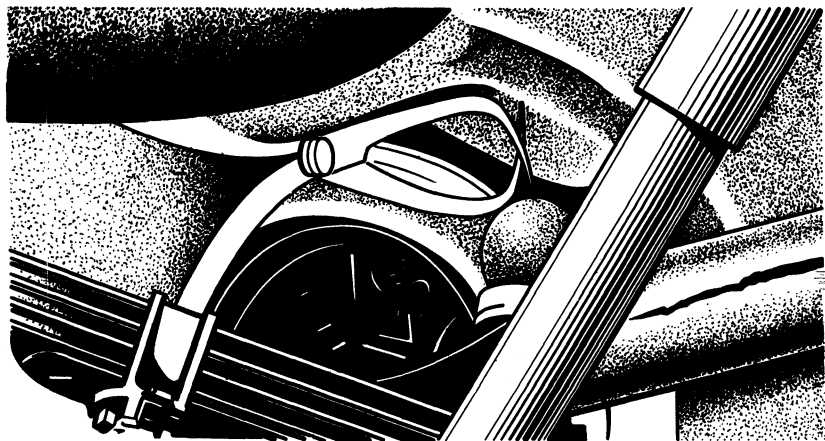
Рис. 236. Проверка прогиба задней рессоры автомобиля «Москвич-2140»
