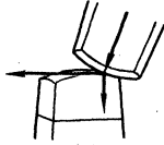
Рис. 25. Удар молотком по головке зубила
