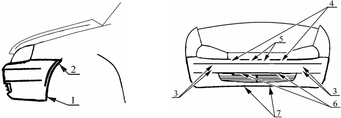
Рис.1. Точки крепления переднего бампера.
