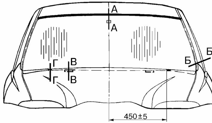
Рис.22. Установка стекла ветрового окна.
