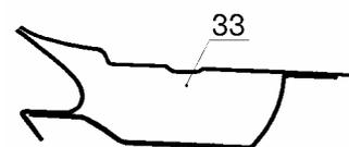
31 – полость нижней поперечины рамки радиатора; 32 – полость между панелью пола передней и усилителем щитка передка нижним; 33 – полости между соединителем и панелью пола передней.
